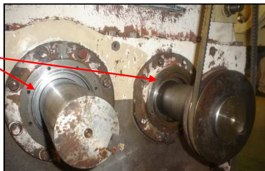
Figura 16 – Detalhe das tampas montadas sem o retentor, simulado o funcionamento do redutor por 46 horas.
