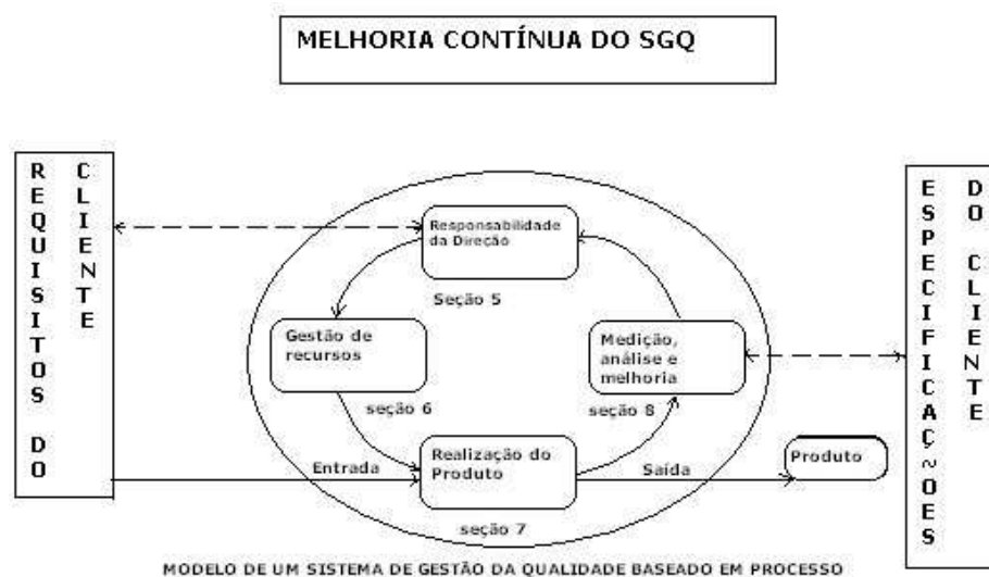
Figura 1 – Modelo de um sistema de gestão da qualidade baseado em processo Fonte: ABNT (2000)
